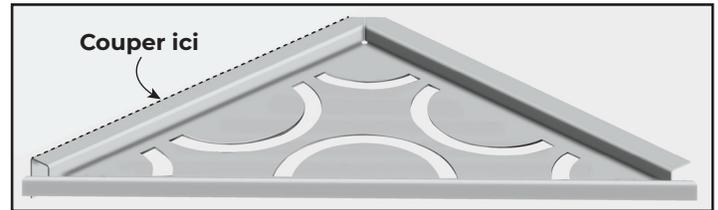
Enlevez le coulis de la ligne marquée, en utilisant une scie à coulis, un outil oscillant ou une meuleuse d'angle, etc.
